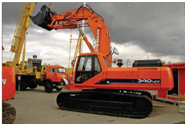
Doosan Solar 340LCV с оборудованием “прямая лопата”
