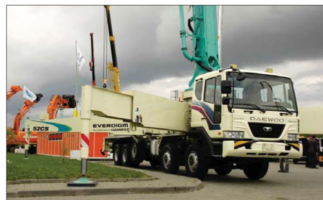
Бетононасос Everdigm 52CS на пятиосном шасси Tata Daewoo
